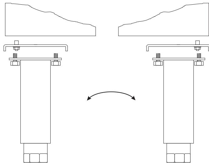
Lösen Sie das Obenscharnier in der neuen Scharnierseite und heben sie die Tür wieder auf das Bodenscharnier auf. Drücken Sie das Scharnier auf der Türfeder und festmachen. Setzen Sie die Schlossschraube ein (siehe Fig. 1.6).
