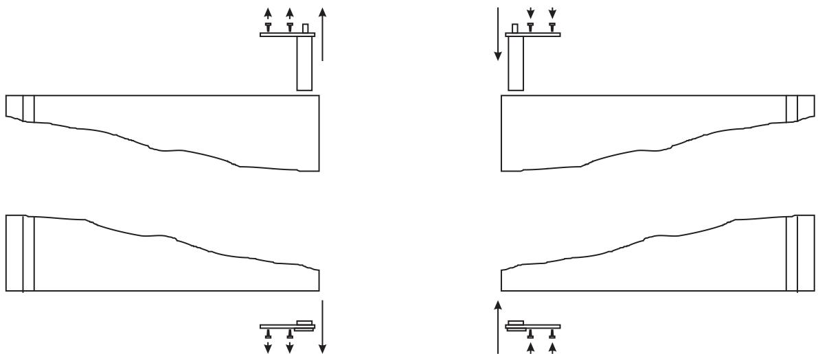
Nedre gångjärnet ska flyttas genom att demontera de främre benen/hjulen och därefter montera på motsatta sidan, se fig. 1.5.
