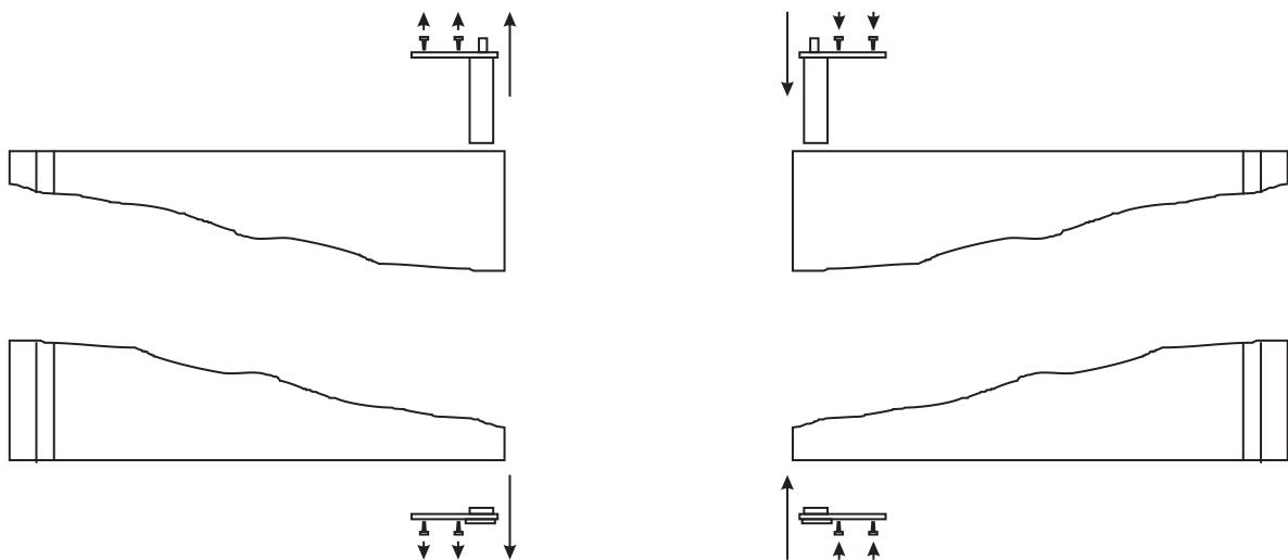
A dobradiça inferior é invertida desmontando-se o pé/roda dianteira e tornando a montar-se no outro lado da arca, conforme mostrado na fig. 1.5.
