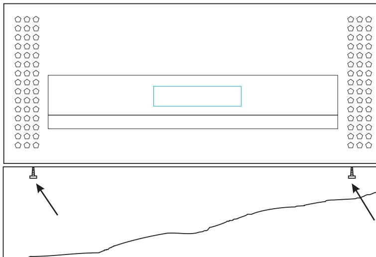
Démonter le vis de blocage dans le ressort de la porte (figure 1.3), la charnière s'est lâchée et vous pouvez démonter la porte.
