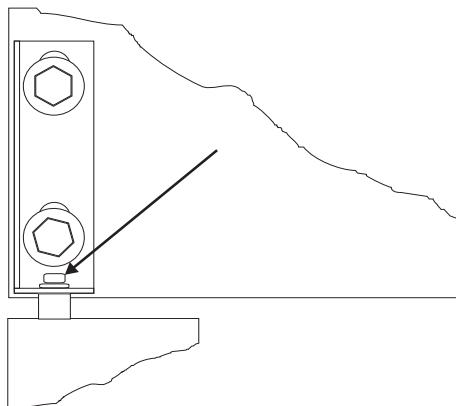
Successivamente, fissare definitivamente le viti di fissaggio del supporto superiore.
