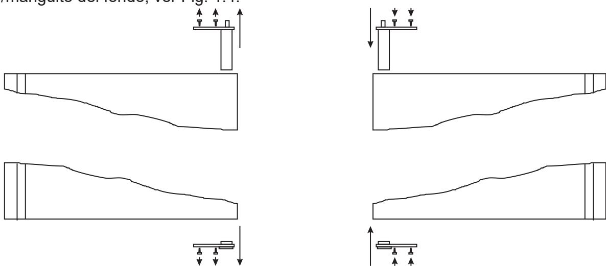
La bisagra inferior es invertida desmontando las patas/las ruedas delanteras, y después las monta en el otro lado del aparato, ver Fig. 1.5.
