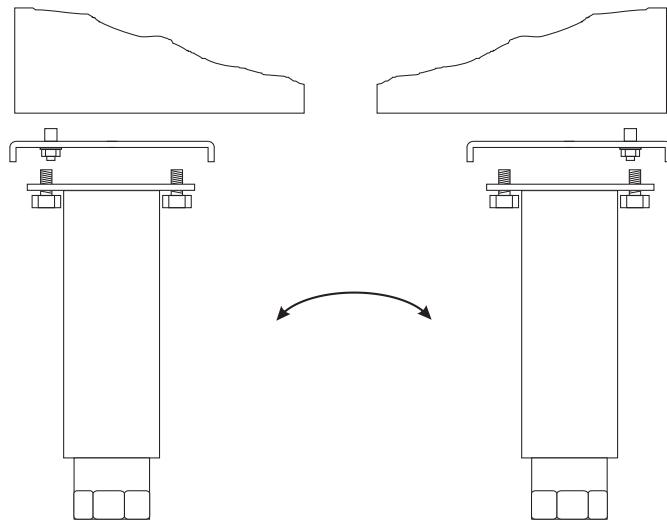
Fissati i piedini, vanno allentate le viti del supporto superiore ed inserita la porta. Controllare l'allineamento e il posizionamento della guarnizione magnetica.
