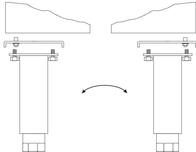
Tophængsel i ny hængselside løsnes og døren løftes på plads på bundhængsel. Hængsel trykkes ned på dørfjeder og fastgøres. Isæt låseskrue se fig. 1.6.
