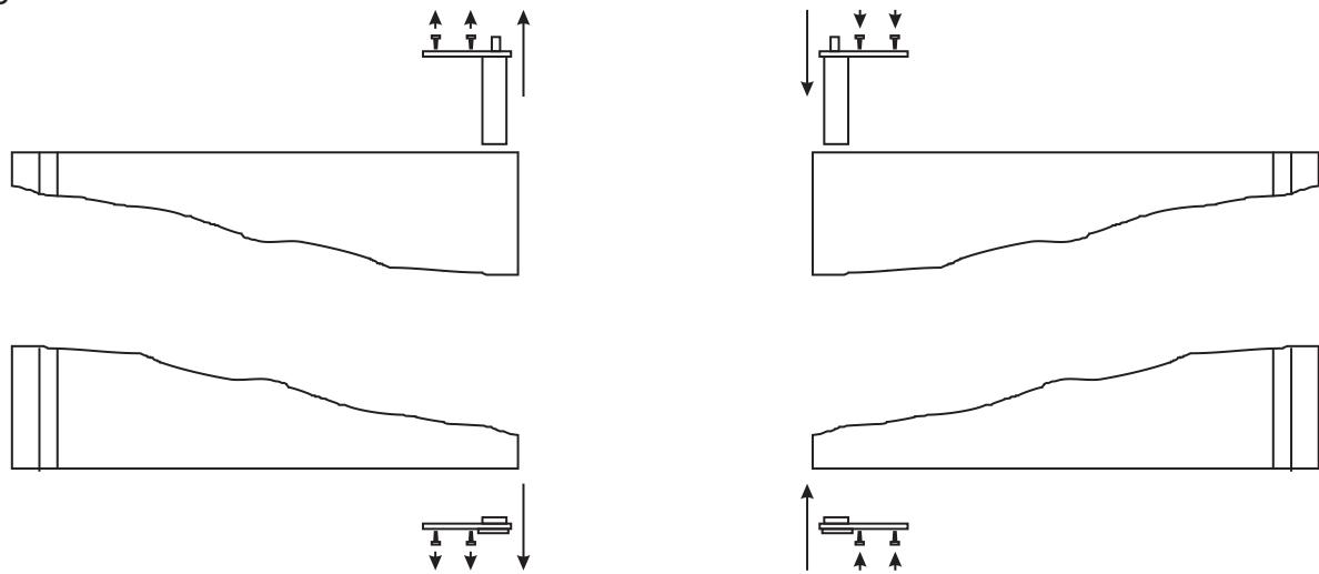
Um das Bodenscharnier zu wechseln muss man die vorne Stellschrauben/Rollen abmontieren und danach das Scharnier in der anderen Seite montieren, siehe Fig. 1.5.
