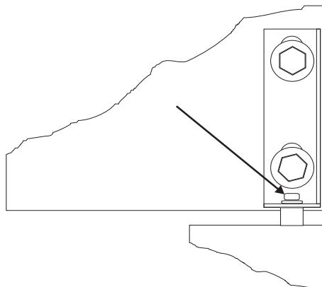
Положите дверь на пол и поменяйте держатель и пружину на другую сторону, рис.1.4.
