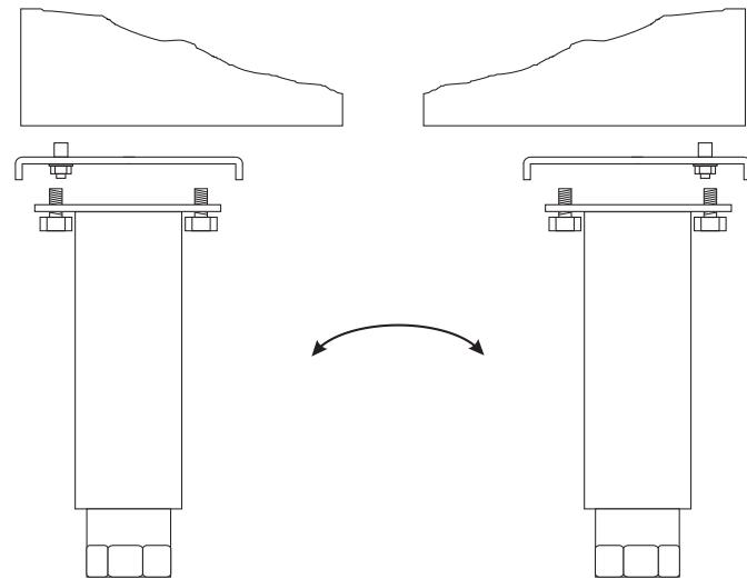
Lâcher la charnière dessus au nouveau côté charnière et monter la porte sur la charnière de fond. Presser la charnière sur le ressort de la porte et fixer-là. Monter le vis de blocage (figure 1.6)
