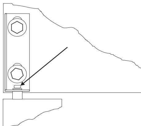
Lås fast och fäst med skruvarna (se fig. 1.7).
