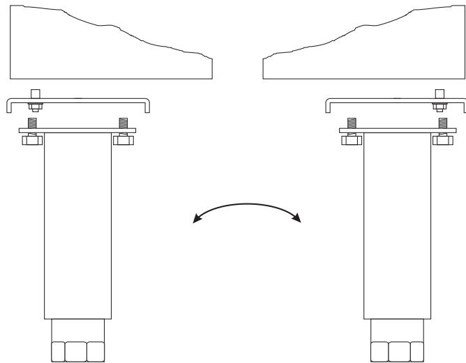
После того как все детали вмонтированы на противоположной стороне, расслабьте верхние петли , поставьте дверь на место, надстроив на нижние петли. Вставьте винт, как показано на рис.1.6.
