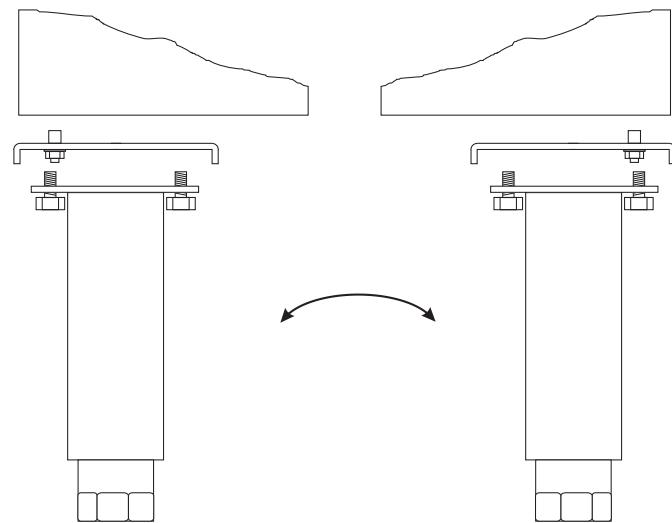
En el lado de la nueva visagra, afloje la visagra de arriba, y coloque la puerta en la visagra de abajo. La visagra se ajusta/aprieta en el resorte de la puerta para que se quede fija. Coloque la contrapuerta, como en Fig. 1.6
