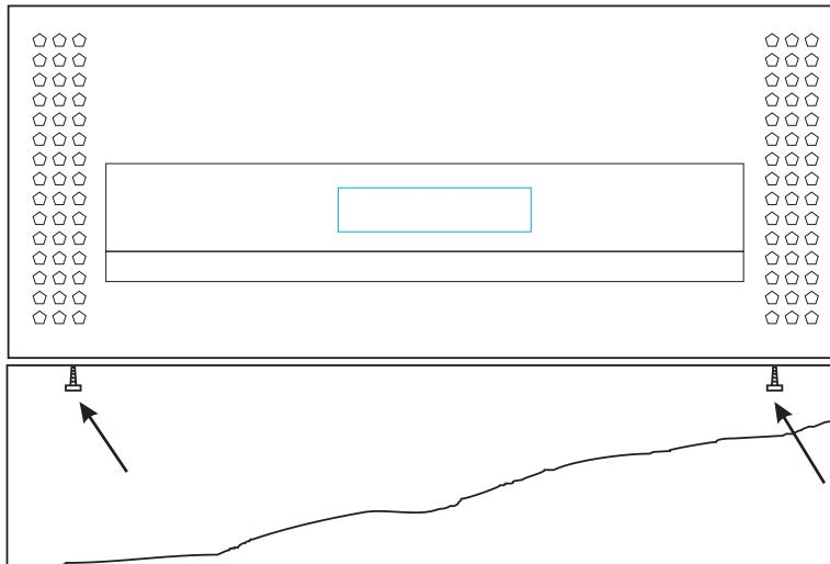
Ta bort låsskruvarna i dörrfjädern, markerade i fig. 1.3, lossa sedan gångjärnet och lyft av dörren.
