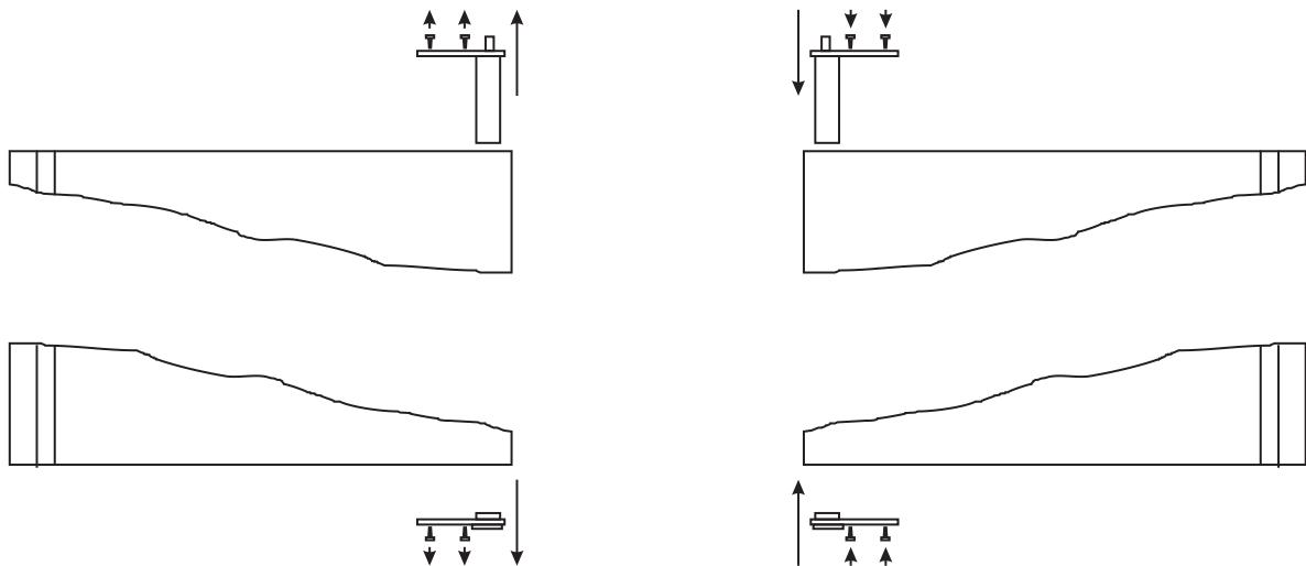
Нижняя дверная петля откручивается после снятия передних ножек, после чего ножки встраиваются на противоположную сторону, рис.1.5.
