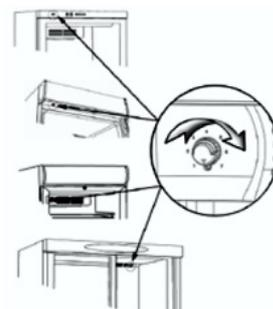
**!** Drehen Sie den Thermostaten auf Stellung „0“, schaltet sich die Kühlung aus. Der Schrank ist aber nach wie vor nicht stromlos!
